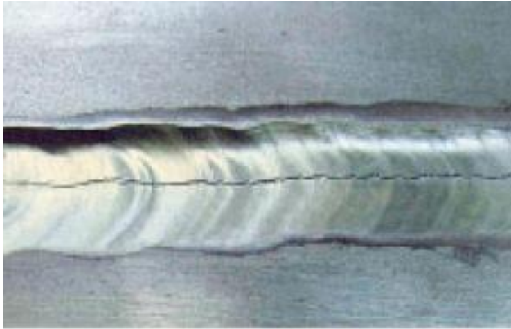
Warmtscheur: stollingscheur hart van de las
