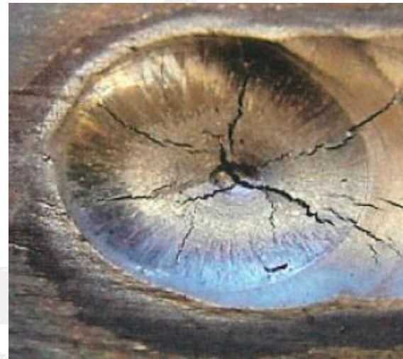
Voorbeeld van typische kraterscheur
